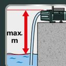
Höhenunterschied zwischen Wasserspiegel und Pumpe
