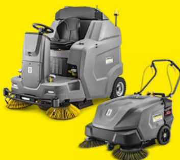
Handgeführte und Aufsitz-kehrsaugmaschinen, auch mit Batterieantrieb für Innenbereiche.
